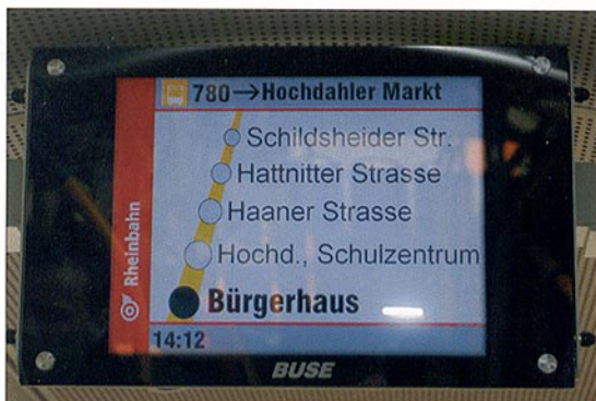
Die Firma Buse lieferte die ersten TFT-Displays zur Fahrgastinformation bei der Rheinbahn. Aufnahme: C. Walther
