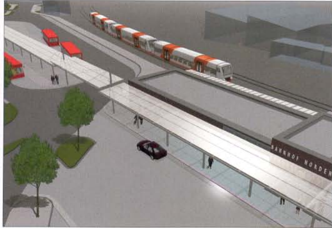
Grafische Darstellung des neuen Bahnhofs mit angrenzendem ZOB der Stadt Norden. Gut erkennbar ist der geplante überdachte Zugang von den Haltestellen zum neuen Empfangsgebäude mit Mobilitätszentrale und Kurzzeitparkplätzen. Abbildung: BPG Bau+Plan/Stadt Norden
